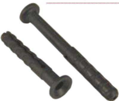
Гвоздевой дюбель используется для сквозного монтажа рам, реек, кабельных каналов, трубных скоб, металлической обрешетки, карнизов, плит ГВЛ и гипсокартона к бетону и кирпичу. Основное его преимущество - быстрота монтажа, так как при производстве работ необходимо лишь забить шуруп в дюбель, не вкручивая его. В местах, где затруднено применение молотка, можно использовать отвертку с максимально возможным захватом шлица.
