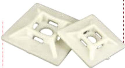
Площадка, как правило, используется для крепления кабельных хомутов на гладких поверхностях при помощи самоклеящегося основания площадки. При производстве наружных работ площадку к поверхности необходимо прикрепить винтом или шурупом, для чего в площадке предусмотрено отверстие.
