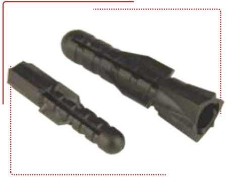
Распорный дюбель предназначен для стандартных креплений в бетоне и кирпиче. Особенность дюбеля - три распорных сегмента, которые не позволяют шурупу смещаться в сторону, а также способствуют равномерному распределению сил внутри отверстия и повышают показатели нагрузок. Такой дюбель имеет блокировочные ребра, которые препятствуют проворачиванию дюбеля в отверстии.
