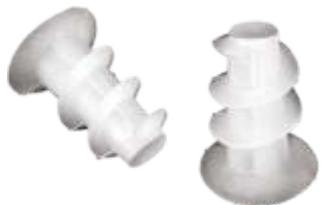
Дюбель саморез "Дрива" предназначен для крепления к гипсокартону толщиной не менее 9 мм светильников, плинтусов, выключателей, кабельных каналов, деревянных реек и так далее. Не требует предварительного рассверливания отверстия и монтируется с помощью специальной насадки. Фиксация дюбеля происходит за счет высокой и редкой резьбы, которая с одной стороны, не позволяет крошиться гипсокартону, а с другой - за счет увеличенной площади поверхности обеспечивает надежное крепление дюбеля в пите.
