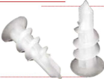
Дюбель саморез "Дрива" предназначен для крепления к гипсокартону светильников, плинтусов, выключателей, кабельных каналов, деревянных реек и других предметов. Не требует предварительного рассверливания отверстия и монтируется с помощью крестообразной отвертки. После монтажа дюбеля к нему прикрепляется материал при помощи самореза. При необходимости дюбель может быть вывернут из стены.
