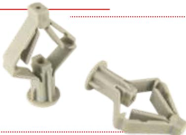
Распорный дюбель бабочка предназначен для крепления к гипсокартону и другим материалам толщиной 10-12 мм светильников, полок, плинтусов, выключателей, кабельных каналов и других предметов.
