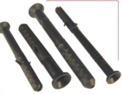
Дюбель предназначен для крепления к бетону, полнотелым материалам, кирпичу с пустотами, пенобетону, всевозможным деревянным деталям, включая обрешетку под штукатурку, рамы, стыковочные стеновые или штукатурные профили, плинтусы, настенные уголки, а также кабельные каналы, зажимы для кабеля и труб, тонколистовой стали и т.п. При использовании гвоздевого шурупа просто забивается молотком.
