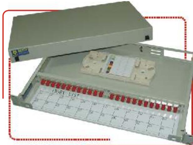
19" оптическая панель высотой 1НУ предназначена для удобного построения оптических распределительных устройств на базе 19" конструктива. Панель оснащается кассетой для сращивания оптических волокон, сменными панелями с разъемами нужного типа (SC, ST, FC) и элементами фиксации кабелей и силового элемента. Максимальная емкость полки 24 порта.
