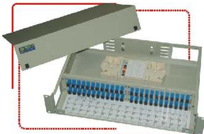
19" оптическая панель высотой 2НУ предназначена для удобного построения оптических распределительных устройств на базе 19" конструктива. Панель оснащается 2-мя кассетами для сращивания оптических волокон, сменными панелями с разъемами нужного типа (SC, ST, FC) и элементами фиксации кабелей и силового элемента. Максимальная емкость полки 48 порта.
