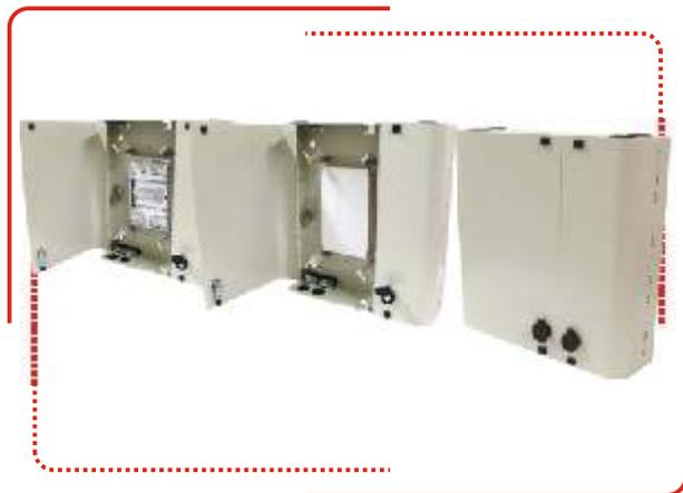
Оптический модульный бокс используется в качестве распределительного устройства для концевой заделки внутренних и наружных кабелей здания. Имеет двойную дверцу с замками обеспечивающую раздельный доступ для организаций, эксплуатирующих сеть и клиента. Оптический модульный бокс оснащен кабельными вводами. В комплект поставки входит кассета для сращивания 12 оптических волокон.
