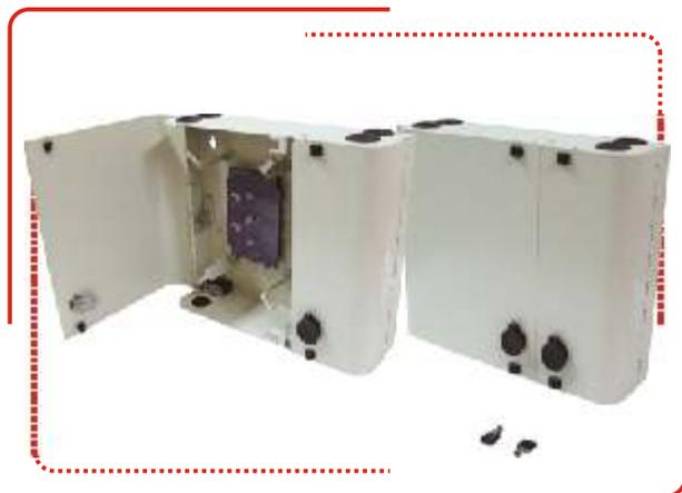
Оптический модульный бокс используется в качестве распределительного устройства для концевой заделки внутренних и наружных кабелей здания. Имеет двойную дверцу с замками обеспечивающую раздельный доступ для организаций, эксплуатирующих сеть и клиента. Оптический модульный бокс оснащен кабельными вводами. В комплект поставки входит кассета для сращивания 24 оптических волокон.
